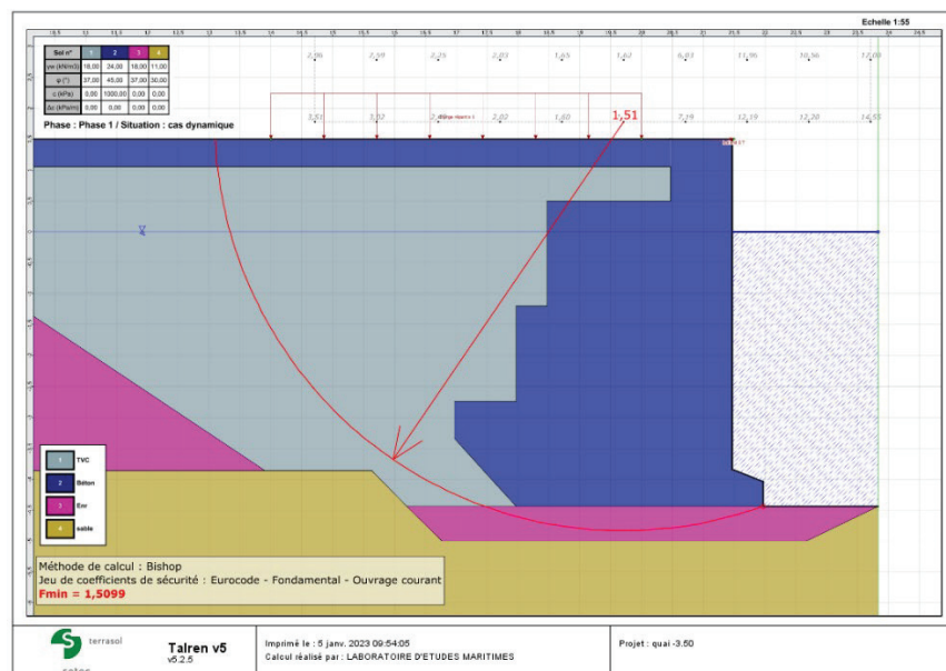
figure 27. Vérifications glissement cercle par TALREN (cas dynamique)
