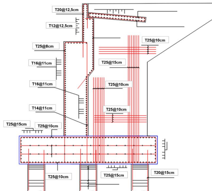
Figure IX.3-8: Disposition des armatures dans la culée
