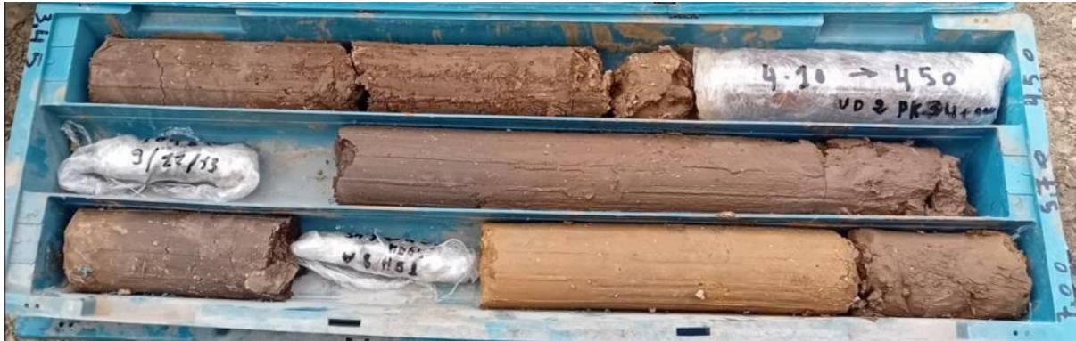
Figure III.35 : Photo de la boîte d'échantillon de carotte du matériau colluvial rencontré dans le projet de forage TBH-8A (entre 3,45 et 7,00 m) (Extrait du Rapport du Projet d'étude du Tunnel de Djimla Portail Sud)
