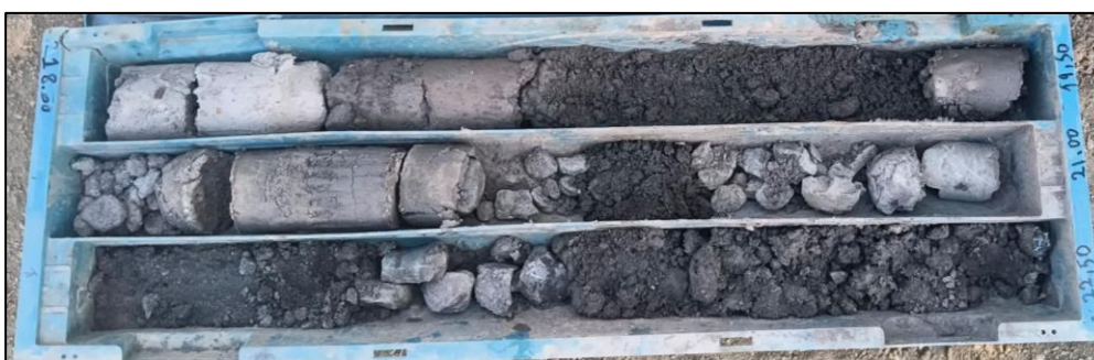
Forage/Borehole TBH-7, Caisse5, 18.00-22.50 m
