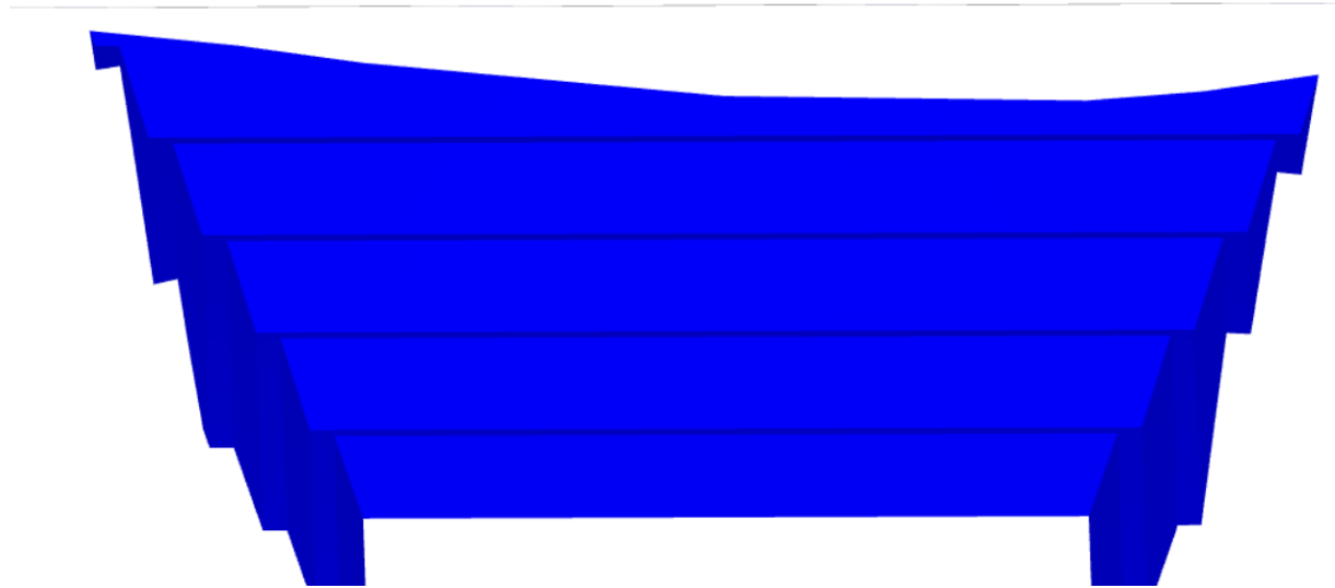
Figure VI.76: Modélisation de la paroi en béton projeté.
