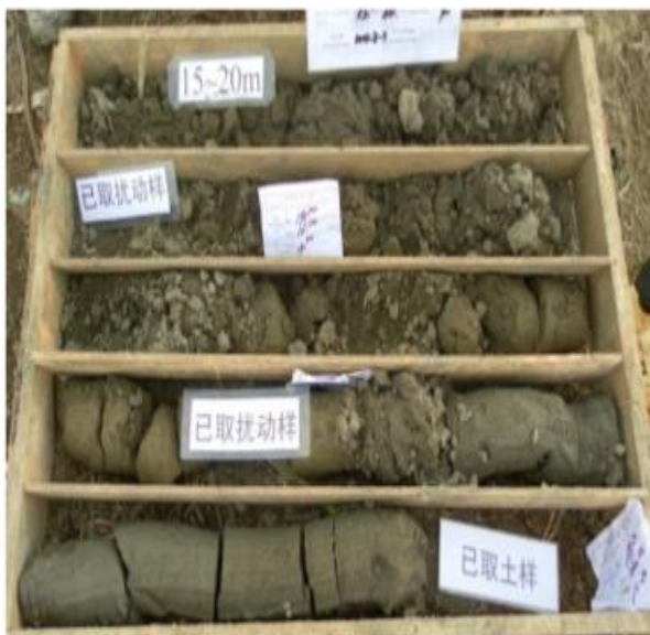
Figure 5-3 BSC11-4 20.0-25.0m Sable fin, Argiles peu plastique
