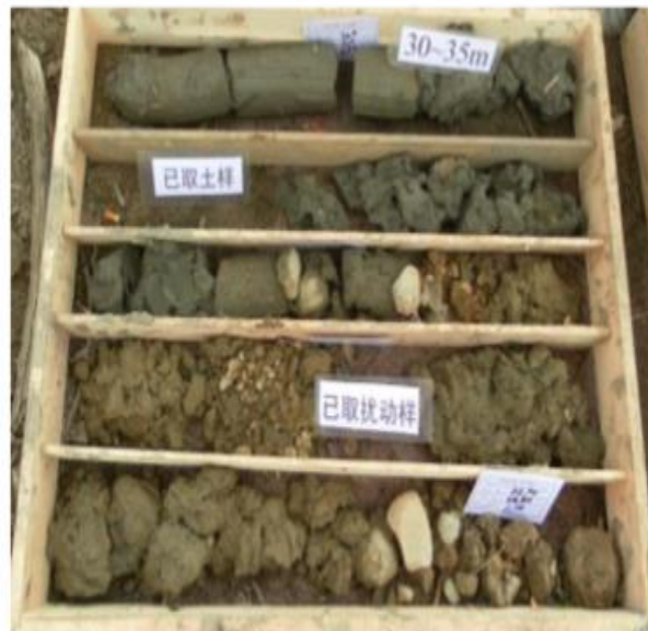
Figure 5-4 BSC11-4 30.0-35.0m Argiles peu plastique,grave
