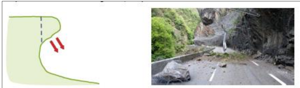
Figure II-2 : Chutes des blocs.
