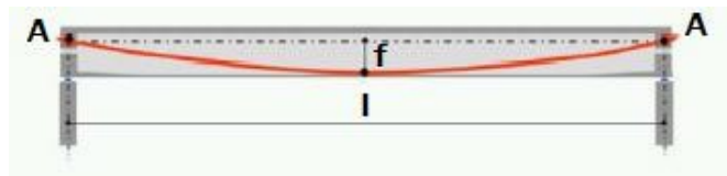
Figure . VI-4 Géométrie des câbles.
