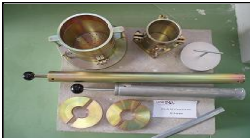
Figure VIII. 40 : Matériel utilisé dans l'essai PROCTOR
