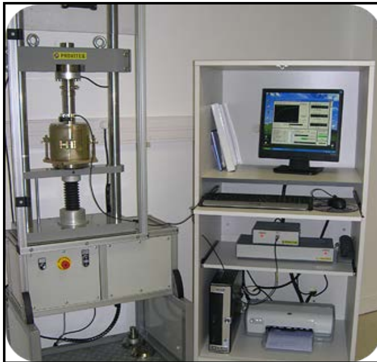
Figure VIII. 41 : Matériel utilisé dans l'essai CBR
