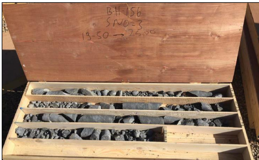
Figure A.1 : Sondage carotté
