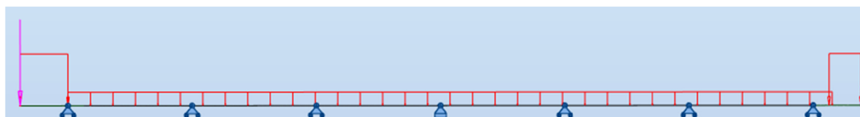
Figure VII. 1 modélisation de la dalle.
