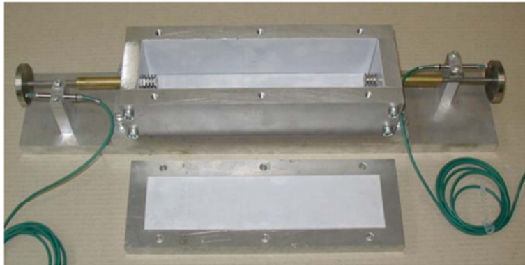
Figure I. 8 Dispositif de mesure linéique du retrait endogène au jeune âge.
