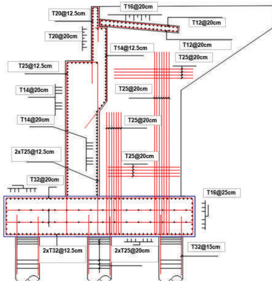
Figure XI.12: Ferrailage de la culée.
