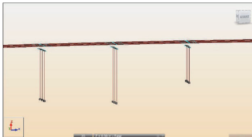
Figure VII.4 : Encastrement des piles au sol.
