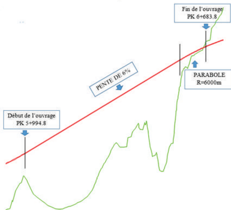
Figure II.4 : Profil en long de la voie portée.
