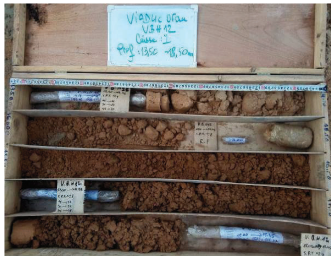
Figure A.1 : Sondage carotté (VBH12) sur 27 m de profondeur.
