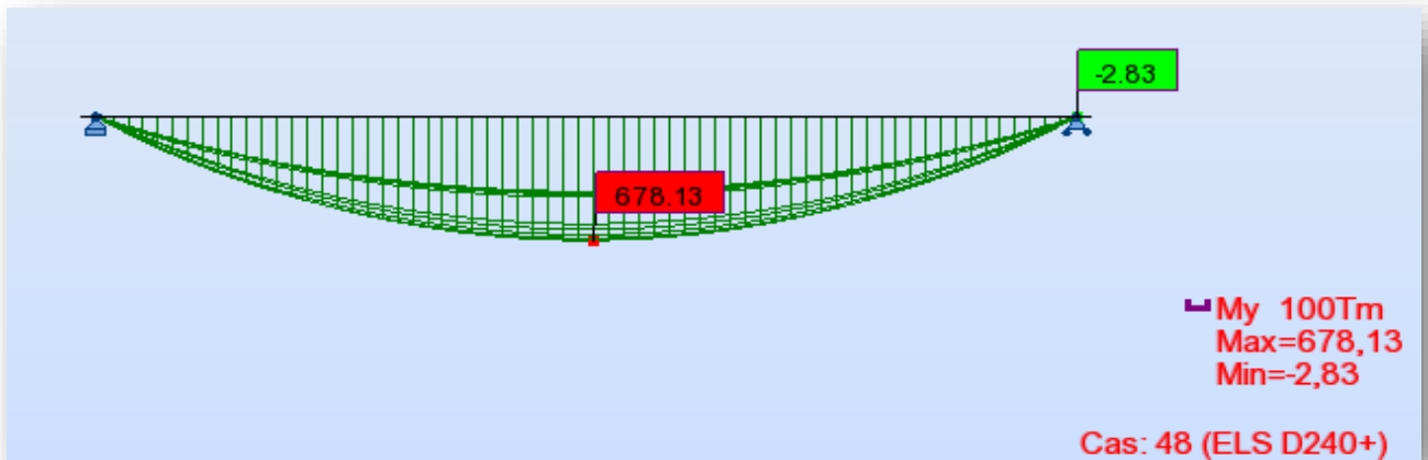
A4.5 : Diagramme du moment fléchissant maximum sous ELS 4 (D240)
