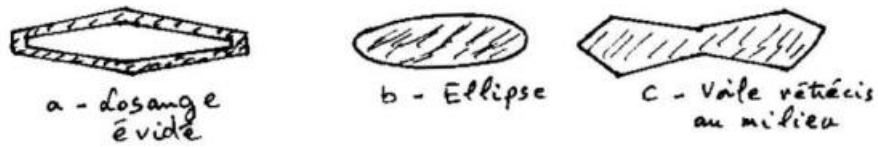
Figure VII-20--Sections hydrodynamiques spéciales formes d'une pile voile en site fluvial
