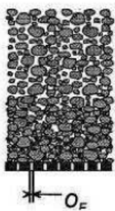
Schématisation de la suffusion
