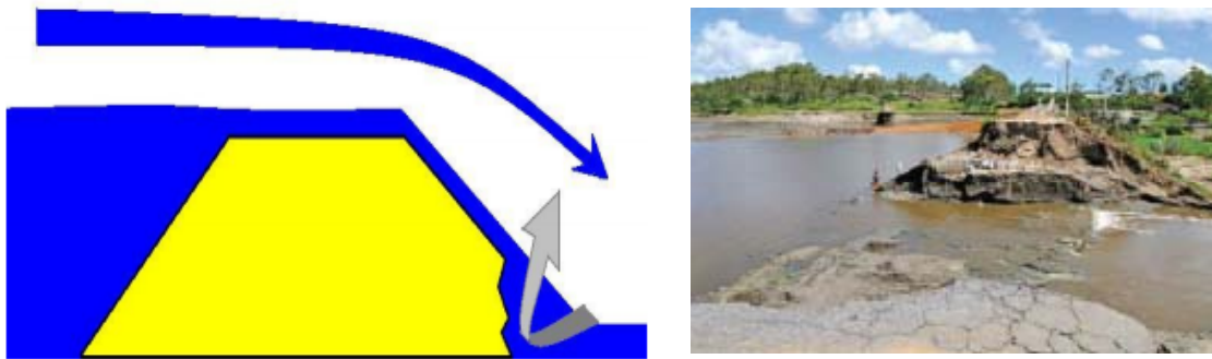
(a) Schématisation de la surverse
