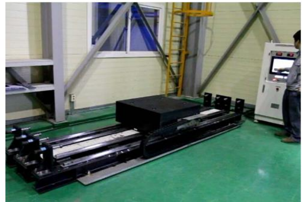
Figure II-8 : Système actif en AMD linéaire et bidirectionnel
