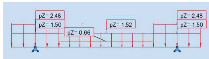
Figure G.11. Schéma statique du chevêtre (1 ère phase)
