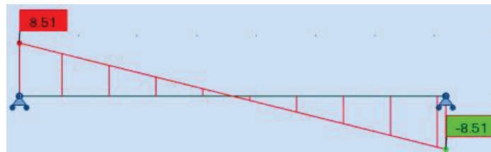
Figure G.4. Diagramme des efforts tranchant de la poutre d'appui
