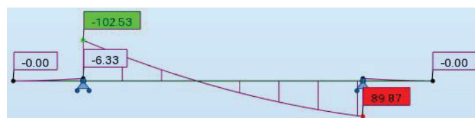
Figure G.21. Diagramme des moments fléchissant de la semelle
