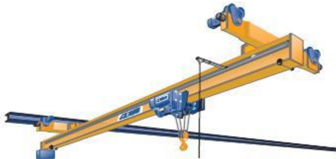
Figure V.3 pont roulant suspendu
