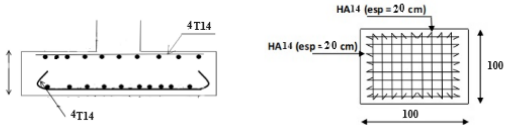
Figure XI.8 Schéma représentatif du ferrailage
