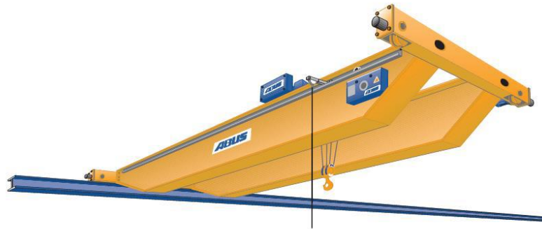
Figure V.2 pont roulant bipoutre
