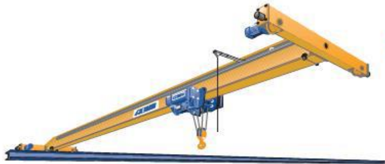
Figure V.1 pont roulant mono-poutre
