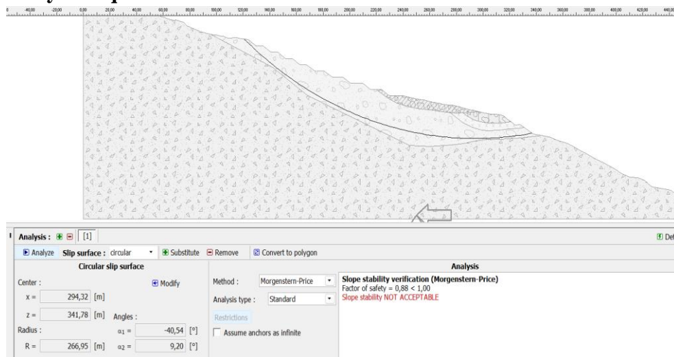
Figure 4-19: Analyse du Cercle de glissement après un confortement par allègement en tête, le coefficient de sécurité égal à 0,88 augmentation de 12%
