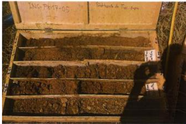
Sondage INC PK17-05 d'une profondeur 8m a 16m
