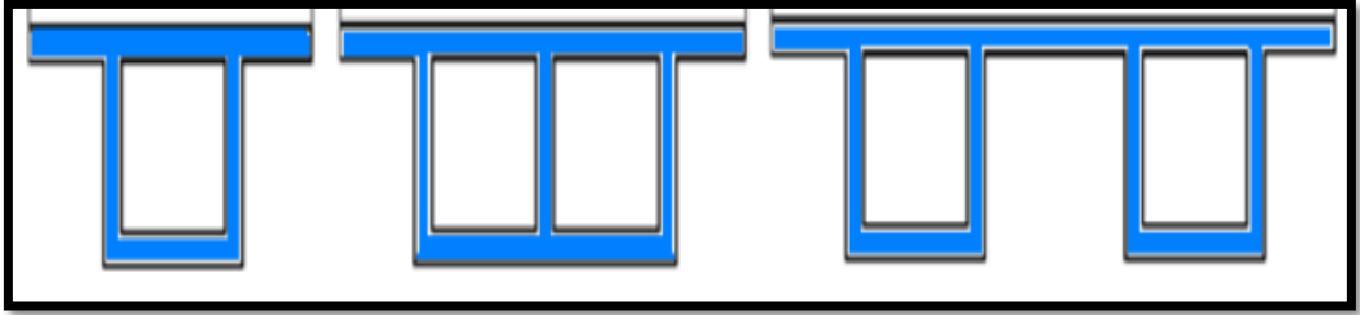
Fig.III-11- Les types des caissons
