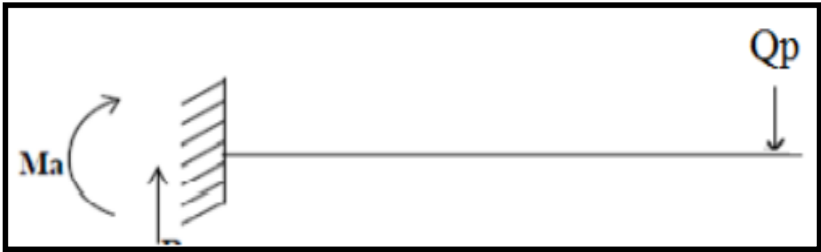
Fig.VI-7- Surcharge de l'équipage mobile.
