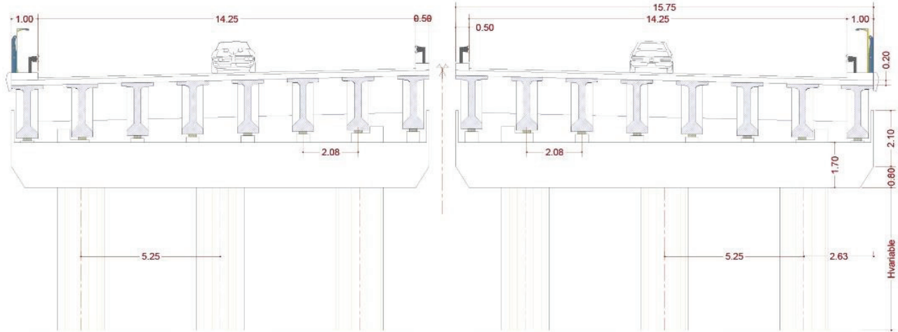
COUPE TRANSVERSALE SUR PILE ech:1/200
