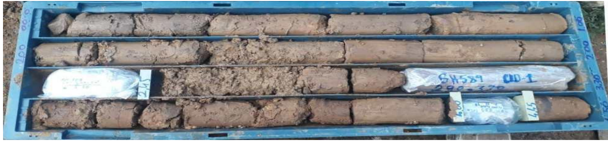
Dépôts colluviaux avec un matériau argilo-sableux généralement (Dc1) observés dans le sondage BH-589
