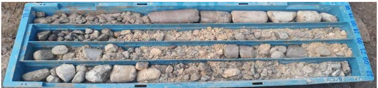
Dépôts grossiers alluvionnaires terrasses composees par des cailloux et des graviers plus ou moins cimentés dans une matrice sableuse limoneuse de couleur grise brunâtre (Dc3) observés dans le sondage BH-589
