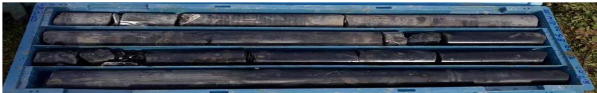
Unité d'argilite faible peu décomposé observée dans le sondage BH-590.
