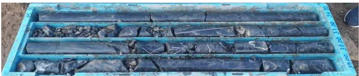
Unité d'argilite faible peu décomposé observée dans le sondage BH-589.
