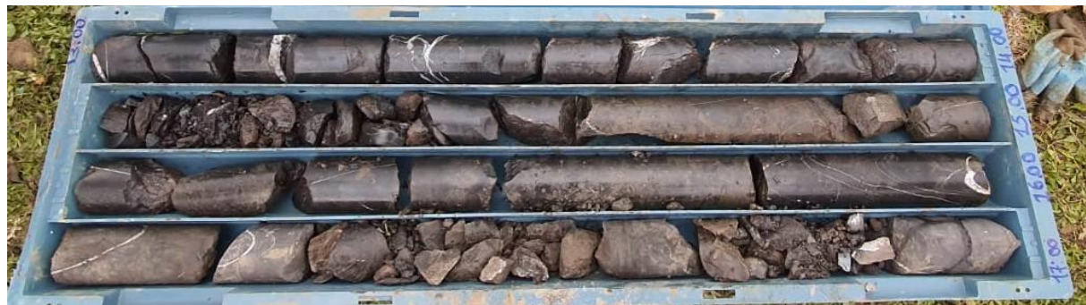
Unité d'argilite faible peu décomposé observée dans le sondage BH-593.
