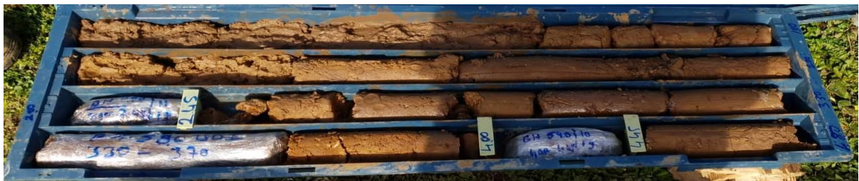
Dépôts colluviaux avec un matériau argilo-sableux généralement (Dc1) observés dans le sondage BH-590
