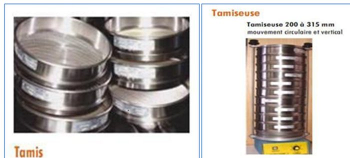
Figure 15 Appareillage de l'essai granulométrique [Source PFE 2011 ENSTP]
