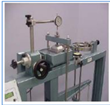
Figure 19 Appareillage pour l'essai au cisaillement [Source PFE 2011 ENSTP]
