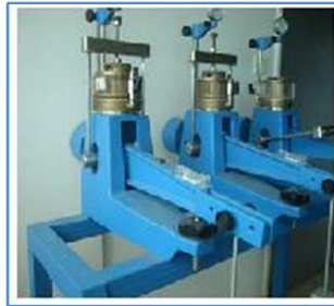
Figure 18 Appareillage pour l'essai œdométrique [Source PFE 2011 ENSTP]
