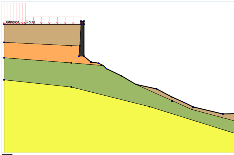
Figure 56 Modalisation de l'état du site juste avant le glissement par Talren 4
