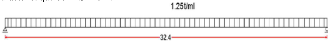
Figure IV. 6 : Schéma train à vide.
