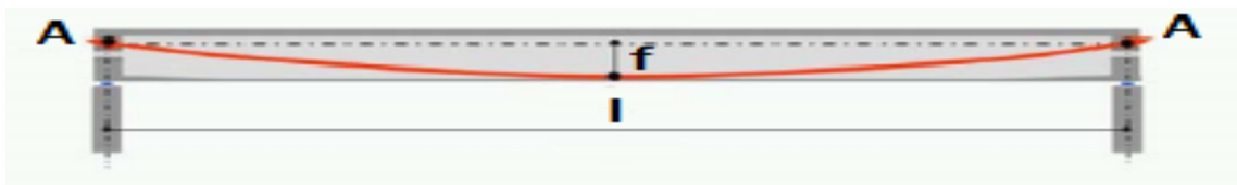
Figure VI. 3 : la flèche d'un câble de précontrainte.
