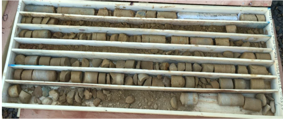
FIGURE 2.5 – Les unités d'argile, et de sable/grès à résistance très faible qui suit BH-107
