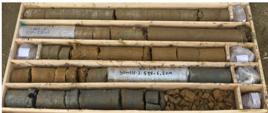
FIGURE 2.4 – Les unités d'argile, l'alternance de sable/grès a résistance très faible qui suit et la couche intermédiaire de marnes observées dans le sondage BH-106
