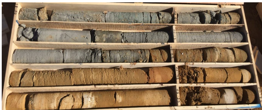
FIGURE 2.6 – Unités d'argile/marne et alternance de marne et de gres a résistance tres faible observés dans le sondage BH-108
