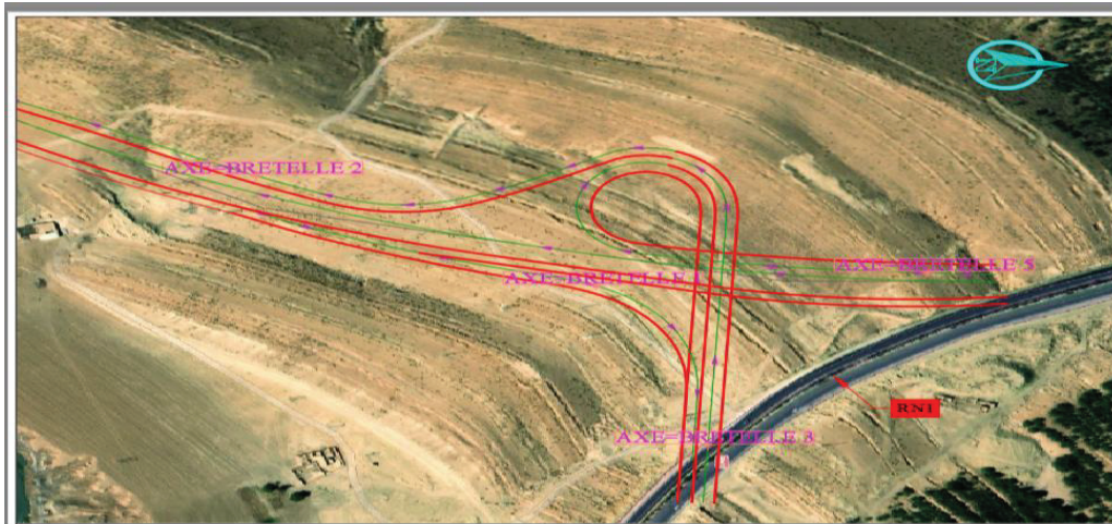
Figure XI-1 : conception de l'échangeur.
