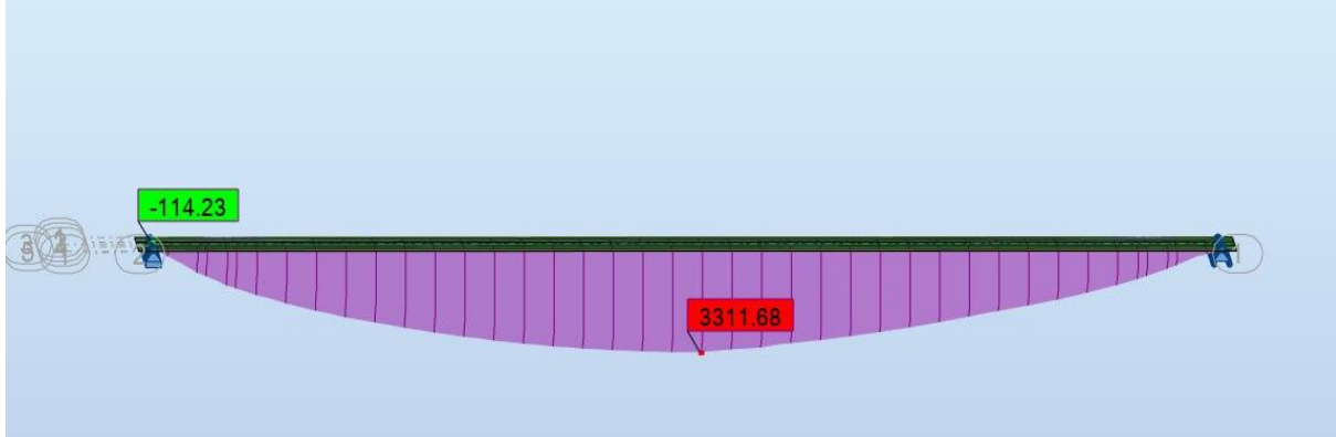
Figure V-9 : Diagramme du moment pour la position défavorable du LM71 sur une voie
