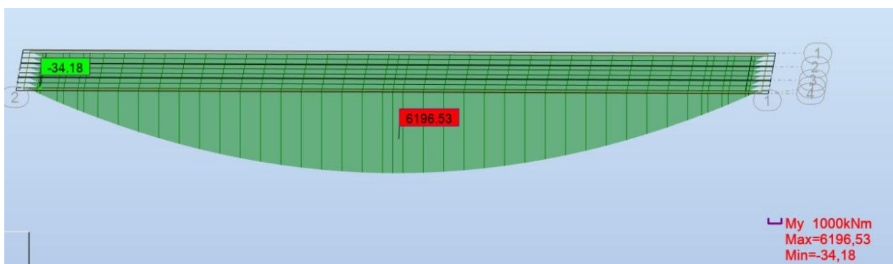
Figure V-8 : Moment fléchissant dû au poids propre
