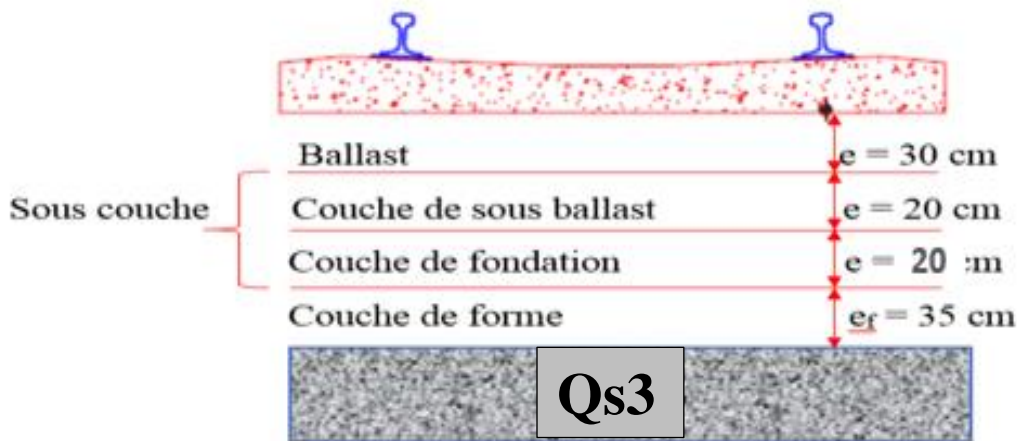
Figure VII-2 : Structure d'assise ferrière
