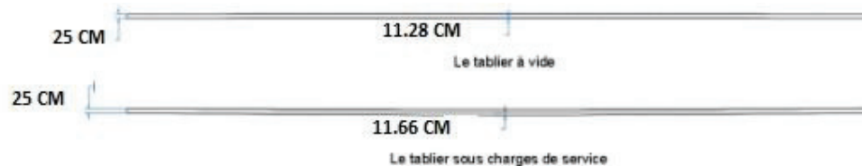
Figure VI.4. Flèches du tablier
