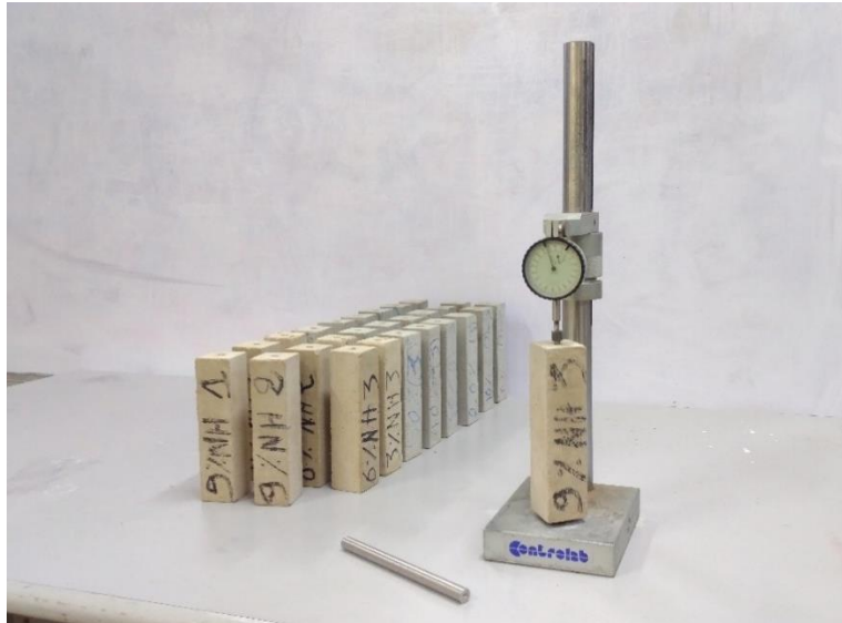
Figure III.9 Appareil de mesure de variation dimensionnelle.
