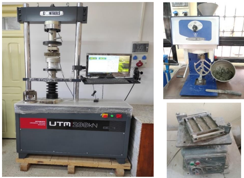
Figure III.8 Appareils de préparation et d'écrasement des éprouvettes de mortier.
