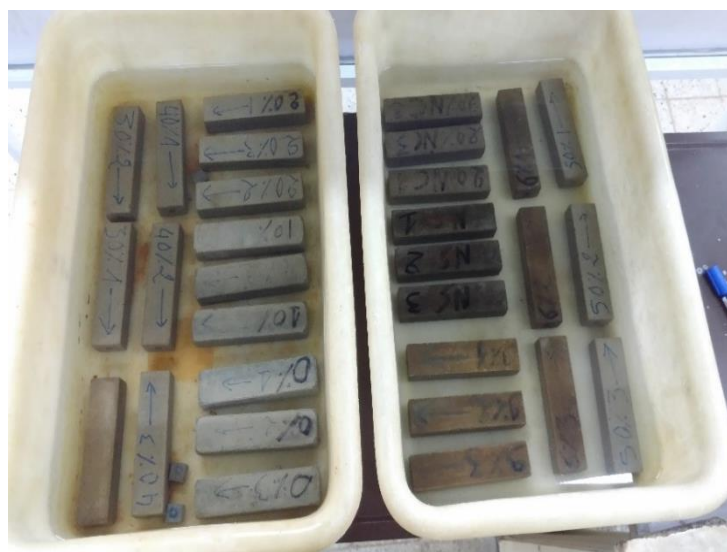
Figure III.3 Conservation des éprouvettes dans le sulfate de sodium.
