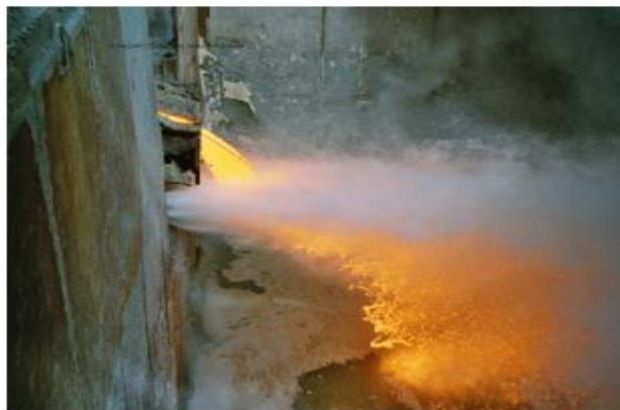
Figure I.13 Granulation et trempe du laitier à sa sortie du haut fourneau d'EL-HADJAR [33].
