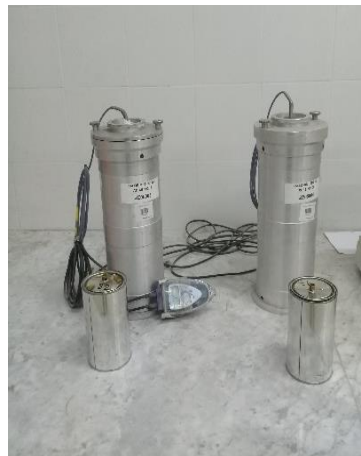
Figure III.10 Appareil de mesure de la chaleur d'hydratation (calorimètre semi-adiabatique).
