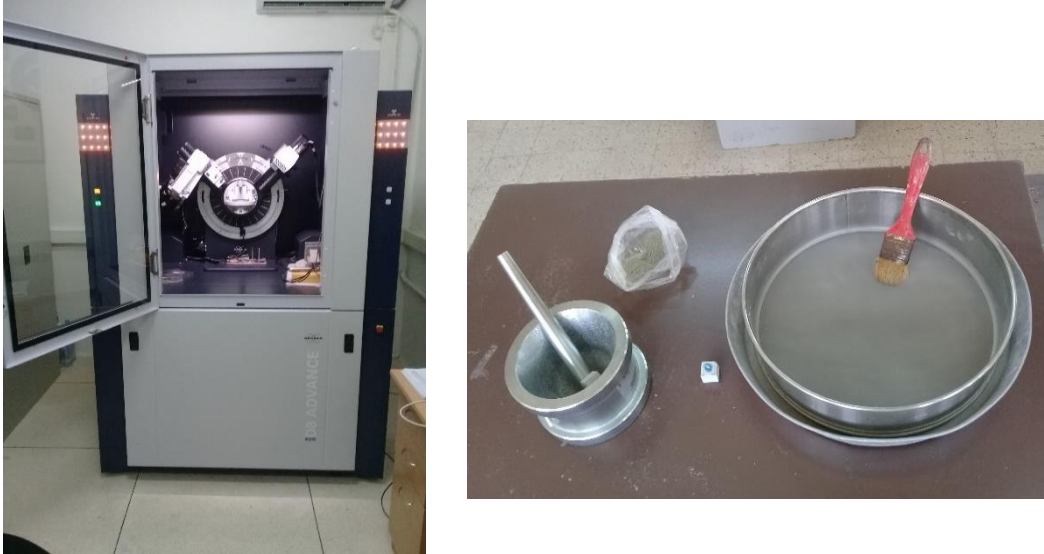
Figure III.6 Appareil de diffractomètre aux rayons X et préparation des échantillons.
