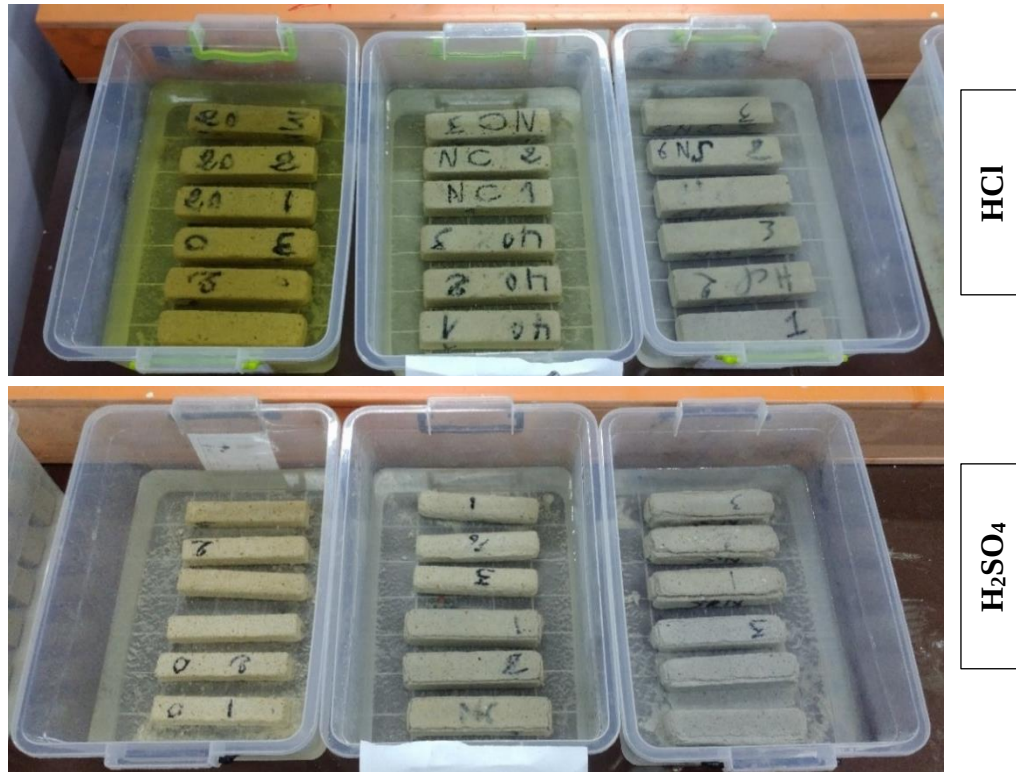
Figure III.2 Conservation des éprouvettes de mortier dans l'acide HCl et H 2 SO 4 .
