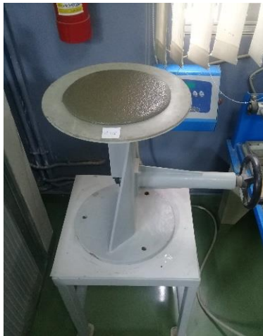
Figure III.1 Appareil de mesure de l'écoulement du mortier (consistance).
