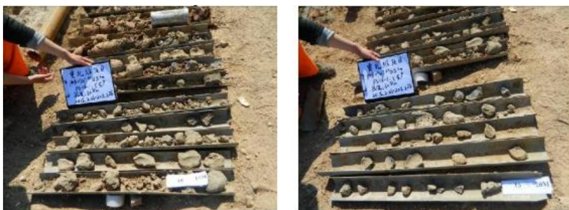
Figure A.2 : Sondage carotté Basalte rocheux sondage a pk 5+741.
