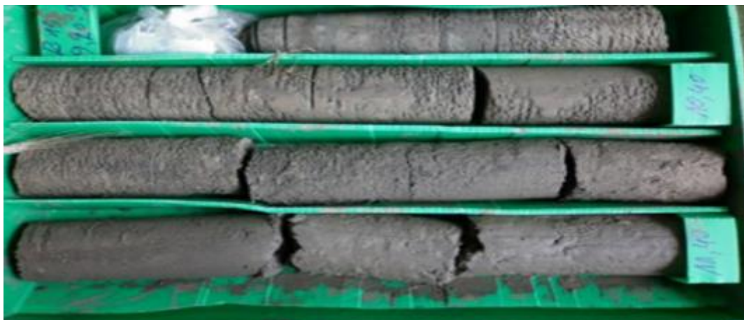
Figure 18 : aspect des marnes argileuse en profondeur (unité T 3 )
