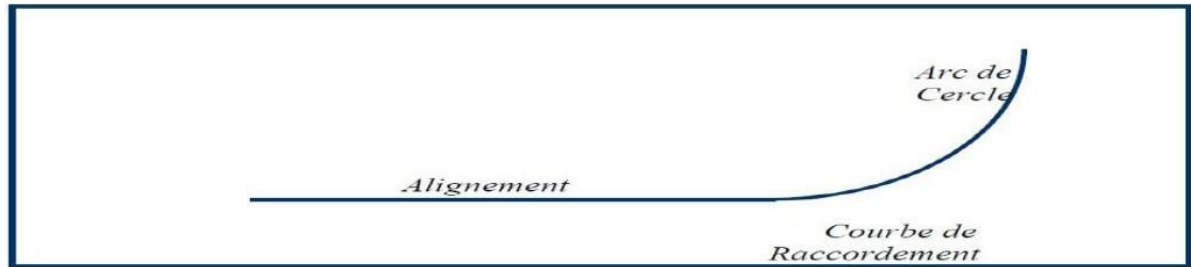
Figure 6: shimatisation segment de tracé en plan
