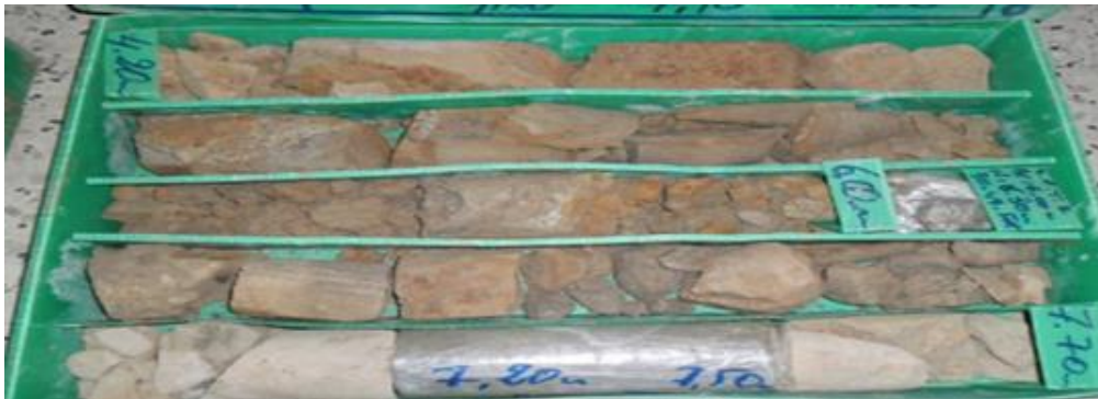
Figure 16: zone d'altération et fracturation de l'unité T 1cg
