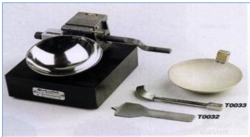
Fig. 12 : Schématisation de l'appareil de Casa grande
