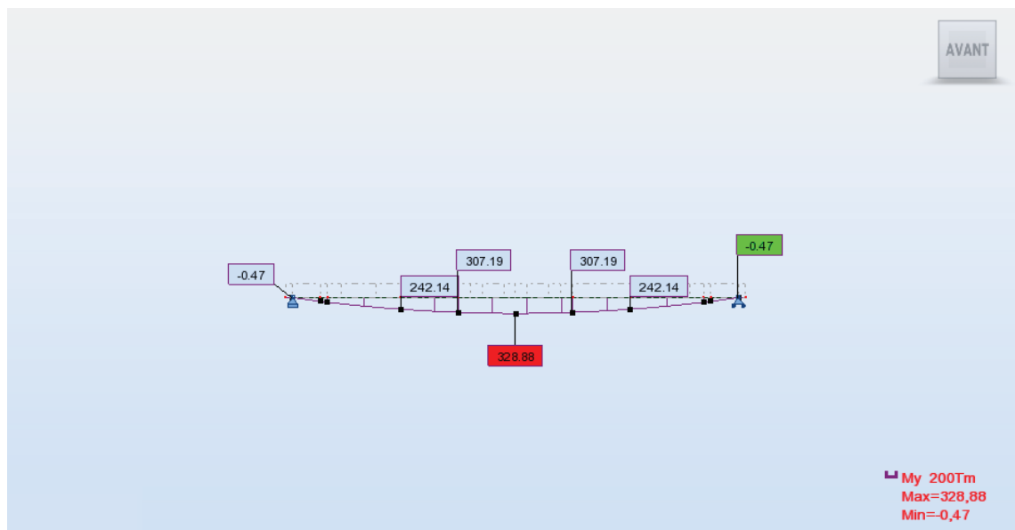
Figure IV. 21 Diagramme des moments sous poutres seules
