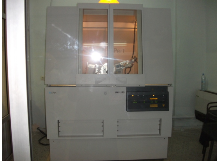
Figure 3.11 Appareil X Pert Pro aux rayons X (Laboratoire de physique, Laghouat).
