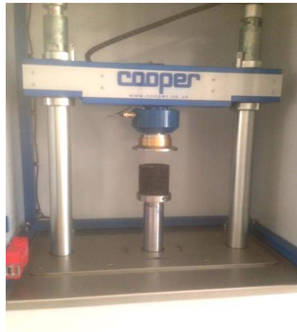
Figure 2.9: Dispositif pour la réalisation de l'essai Duriez
