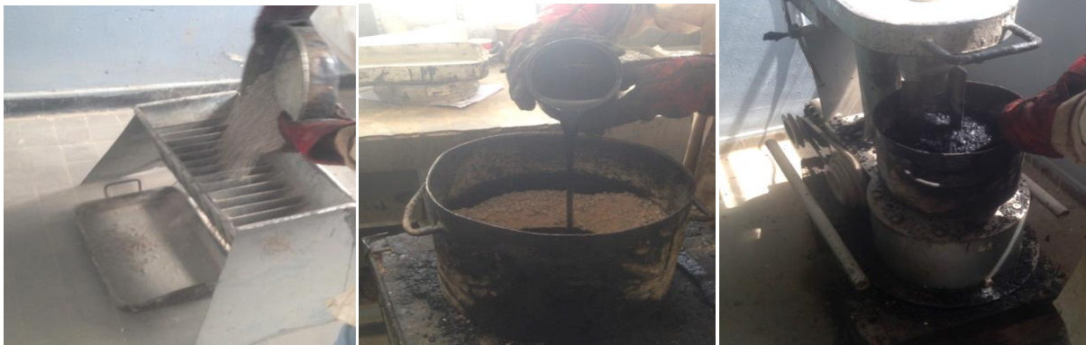
Figure 4.5: Confection des éprouvettes (De gauche à droite : échantillonnage, incorporation du bitume liquide et malaxage).
