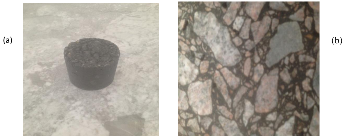
Figure 2.6: (a) Eprouvette d'enrobé bitumineux, (b) Coupe d'un enrobé bitumineux.
