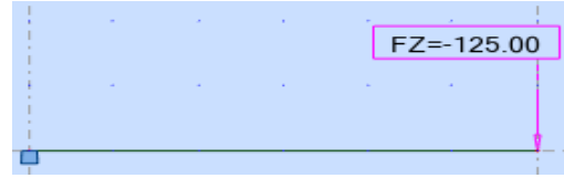
Figure VI.4. Schéma statique 2 du couronnement du quai à -4.00m
