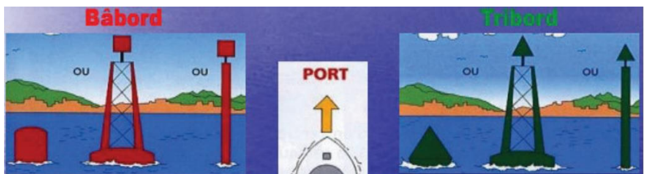
Figure I.5 Balise qui impose un sens de passage
