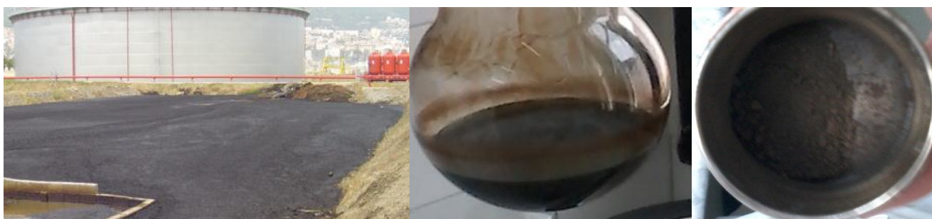
Figure III.8. Le résidu pétrolier et leurs composantes (partie organique et solide)
