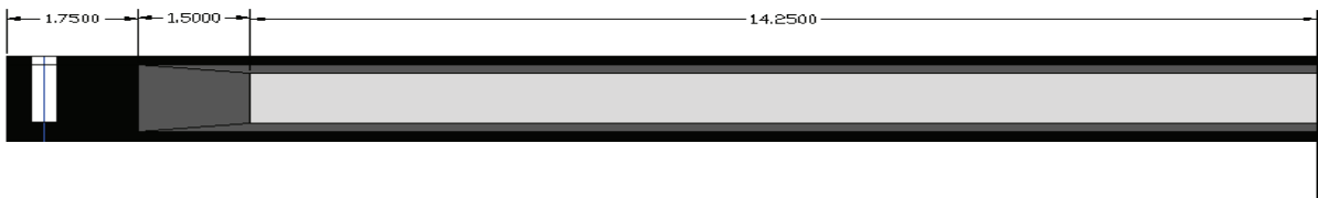
Figure V.1. Vue longitudinale de la poutre représente la variation de la section transversale
