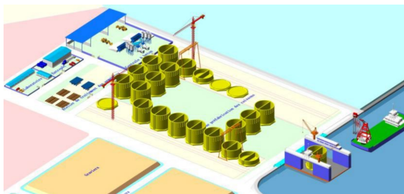
Figure II.19 : la zone de préfabrication des caissons
