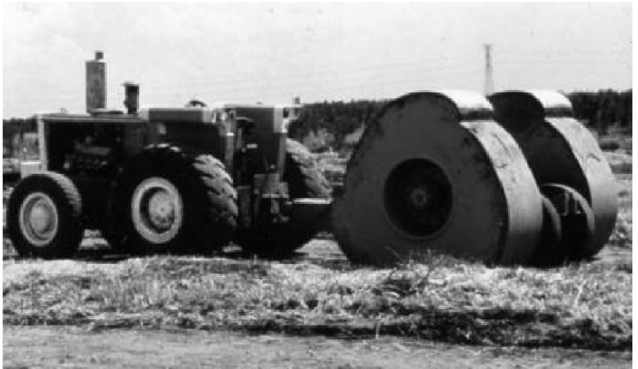
Figure IV.02 : Compacteur à rouleau à chocs
