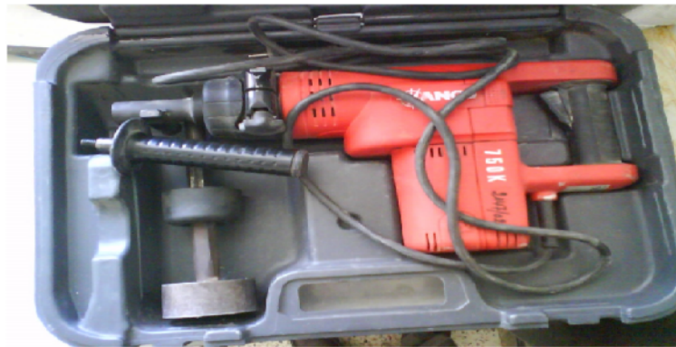
Figure VI.06 : Le marteau vibrant et son piston dans leur valise
