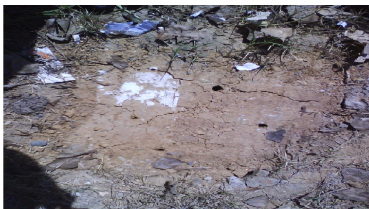
Figure IV.32 : Etat du sol dans la fosse compactée l'OPN après l'ensoleillement.
