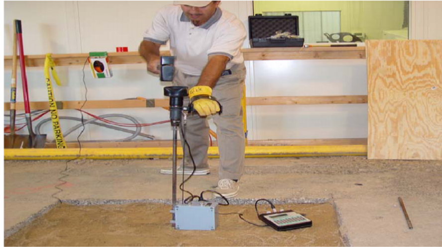
Figure V.07 : Essai avec le PANDA dans la section à intérieur de la fosse (APWA; 2005)
