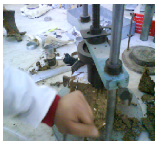
② L'enfoncement de la Carotteuse
