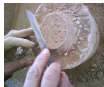
③ Le surfaçage de l'anneau enfoncé
