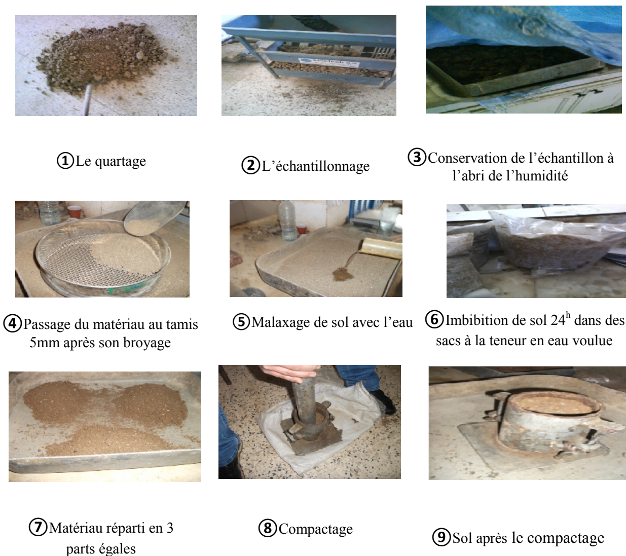
Figure VI.04 : Étapes de réalisation de l'essai Proctor normal.
