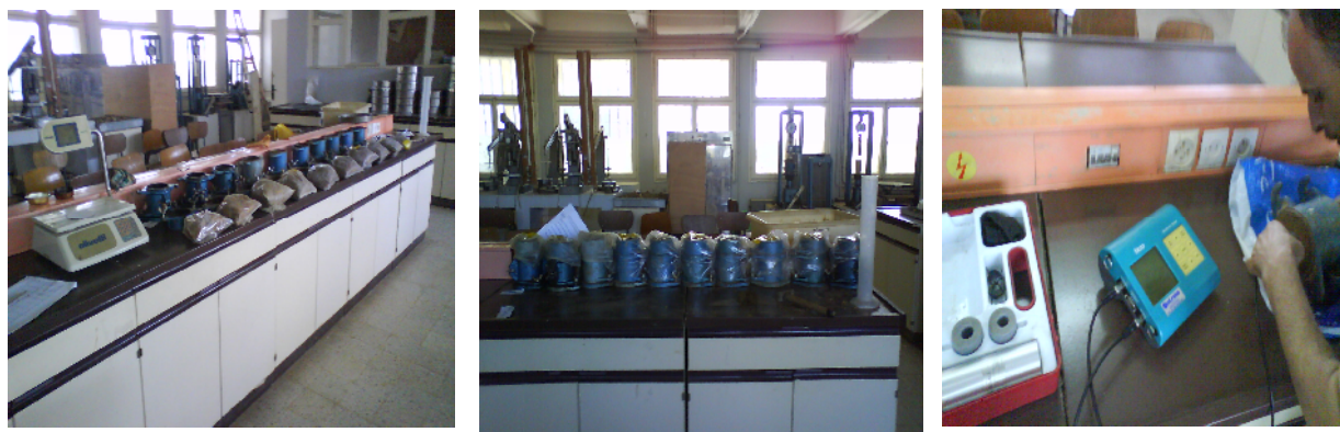
① Préparation de l'échantillon pour le compactage ② Conservation de l'échantillon après le compactage durant 24h ③ Prise de la mesure avec l'appareil à ultrasons
