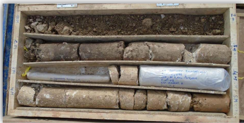
Figure I.6. Caliche dans le sondage SC-AM-0+075, sous remblai artificiel.
