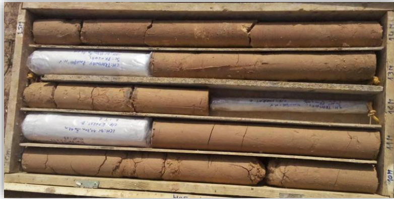
Figure I.5. Section de marnes dans le sondage SC-AM-0+075 (de 10 à 15 mètres).
