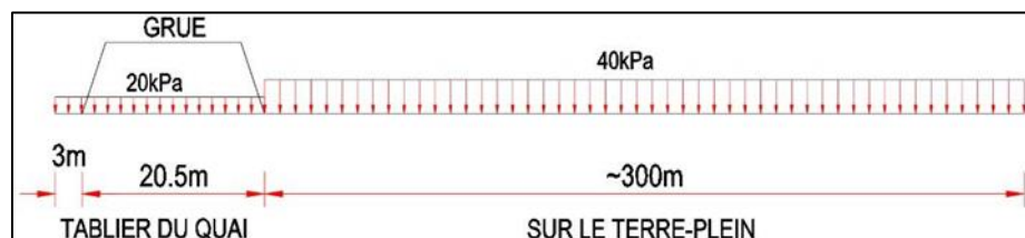
Figure 40. Diagramme d'une charge uniformément répartie.
