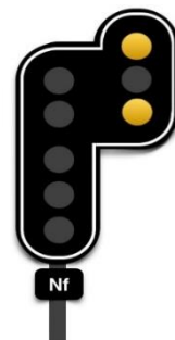
Figure N°XI- 7-rappel de ralentissement à 30km/h
