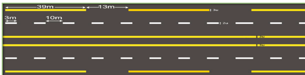
Figure XI.5 : caractéristiques des lignes d'une chaussée.
