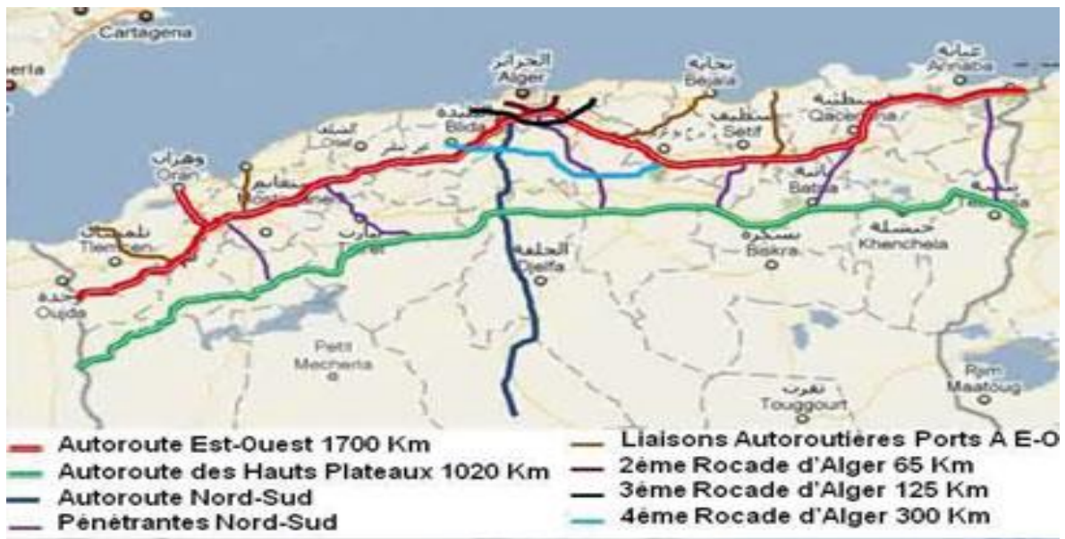
Figure I.1: réseau routier algérien (Source : site web ADA)
