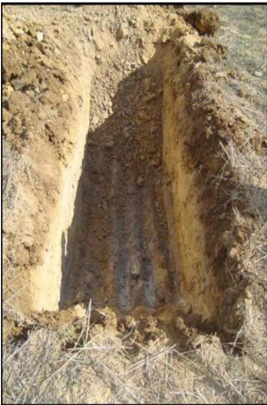
PK 17+480 (marne jaunâtre à grisâtre surmonté d'une couche de terre végétale.
