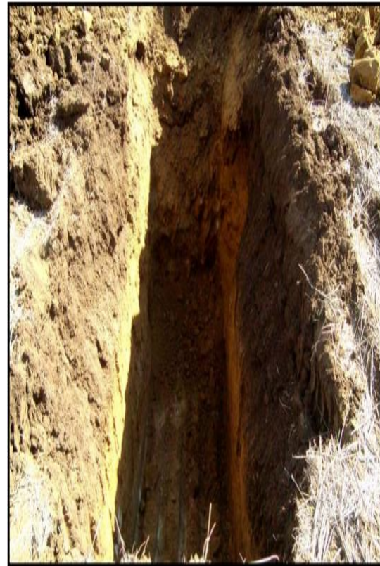
PK 18+080 ((Argile limoneuse marneuse jaunâtre a brunâtre repose sur un couche d'argile marneuse
