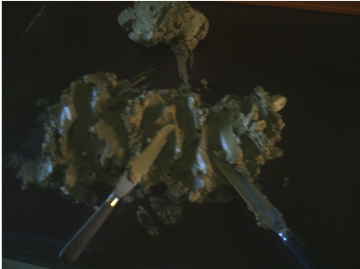
Figure 5-5 un mélange reconstitué (tuf + bentonite)
