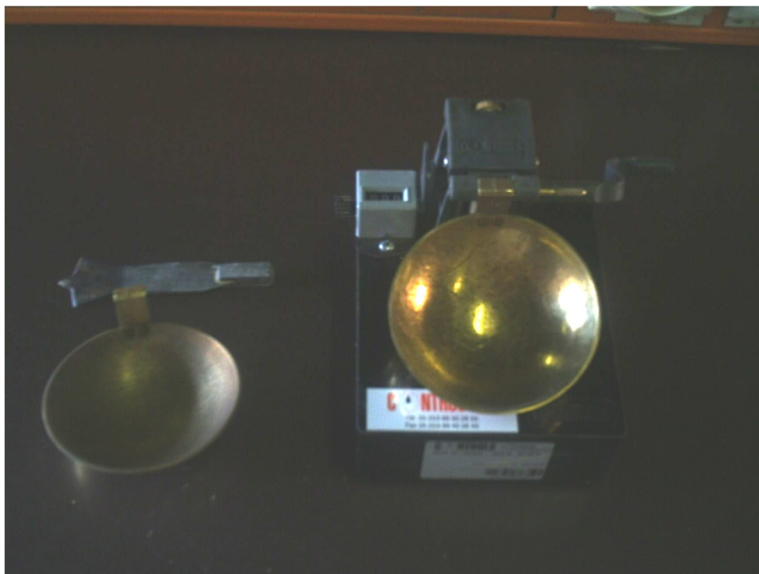
Figure 5-4 Appareil à percussions de Casagrande (Laboratoire de recherche de l'ENTP)
