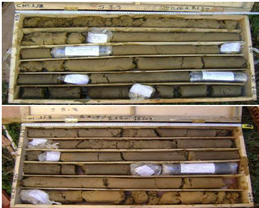
Échantillons des sondages carottés (Pk : 156+900)
