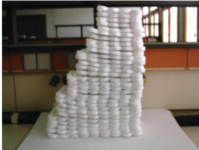
Photos.V.5. Vu d'ensemble des nappes utilisées – cas des murs à redans
