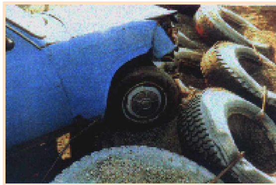
Photo.III.19.Essai de choc frontal sur un séparateur de trafic en pneusol.
