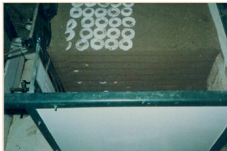
Photo.VII.3. Observation du prisme de rupture au sein du massif avec inclusions de pneus. (Cas des inclusions en nappes sans attaches)
