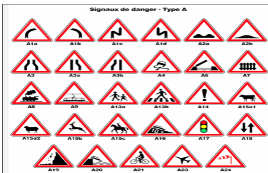
Figure XI-1 : Signalisation de danger type A
