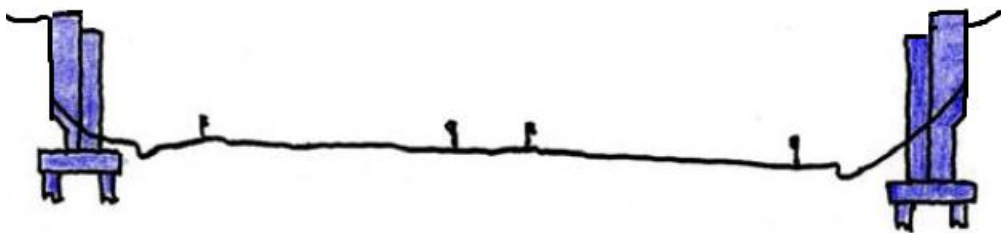
Figure IV.8 : 2 ème étape. Réalisation des culées.
