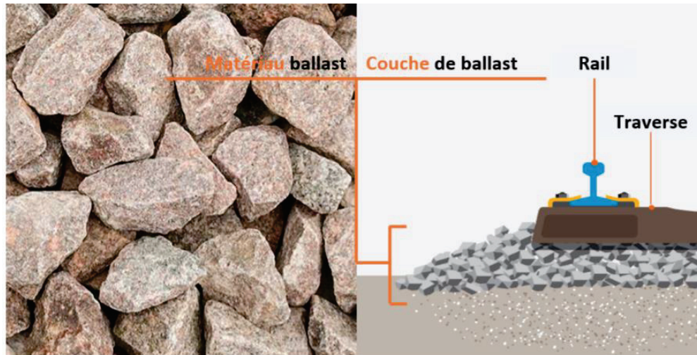
Figure I.3 Le ballast : le matériau (gauche), et la structure couche dans la voie (droite)
