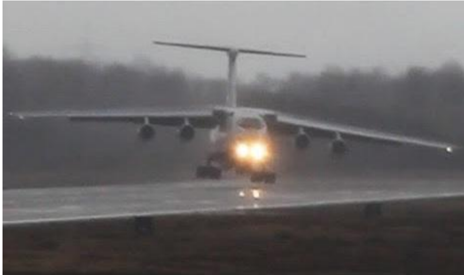
Figure II.2. Atterrissage d'un Ilyushin Il-76 sous l'effet de girouette
