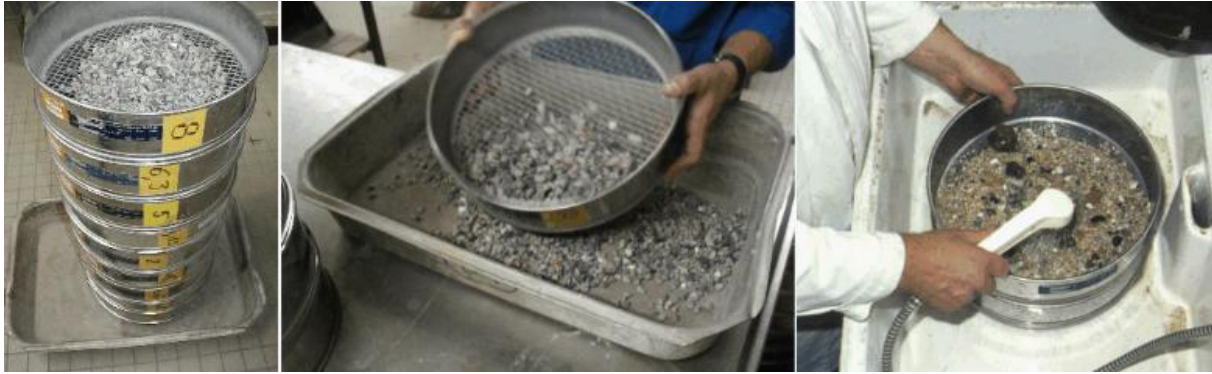
Figure.V.1. Essai de granulométrie par tamisage
